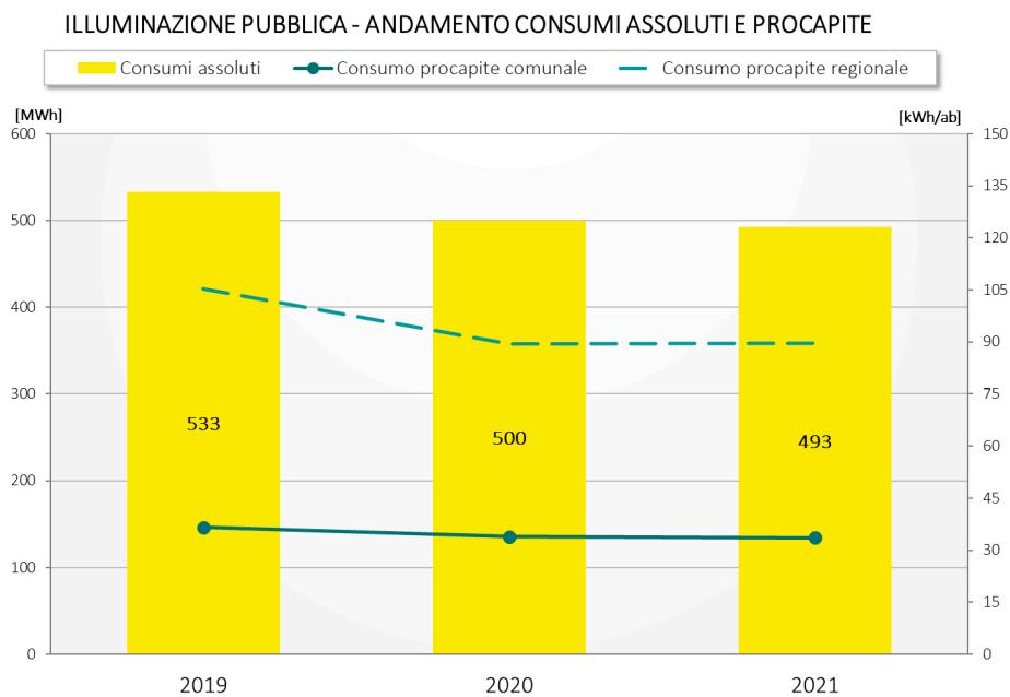
L'evidente riduzione dei consumi avvenuta tra 2019 e 2021 è una conseguenza di alcuni progetti di efficientamento energetico che ha portato alla sostituzione delle lampade di vecchia tecnologia (SAP, vapori di mercurio, ioduri) con nuove lampade LED.
