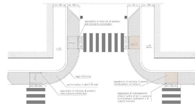
**3.4 Ampliamento del marciapiede in area di incrocio sopraelevato eliminando il cordolo esistente**
